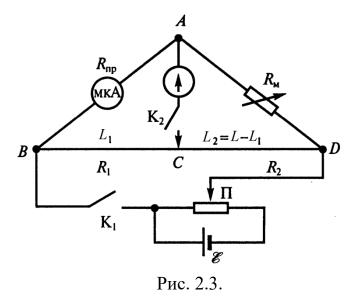
В качестве нижней половины моста (точки B и D) используется реохорд, который представляет собой отрезок тонкой проволоки из материала c высоким удельным сопротивлением, натянутый деревянной подставке. Это как бы вытянутый в длину реостат. На той же подставке спереди расположена металлическая шина в виде отрезка проволоки зажимами, c которая используется в качестве точки A при монтаже установки.
